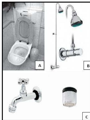
Figura 21 – Equipamentos Hidráulicos Economizadores de Água: a) Vaso Sanitário Segregador de Urina; b) Ducha Temporizadora; c) Torneira com Arejador
