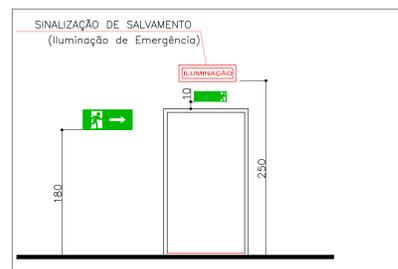
08 DETALHE ILUMINAÇÃO DE EMERGÊNCIA
